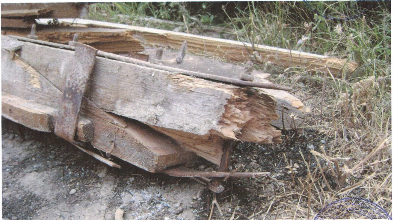
Фото №28. Место излома несущей деревянной балки.
